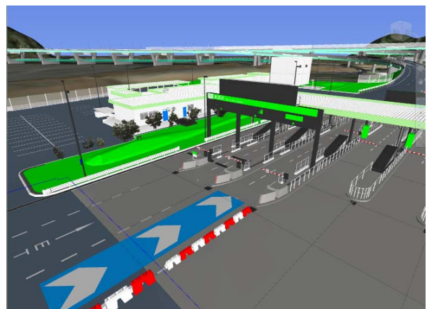
図-8 3次元モデル作成例 (料金所)
