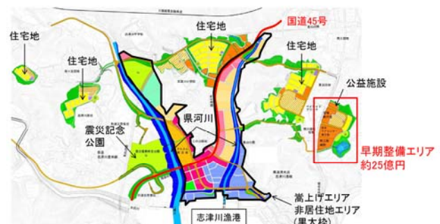
【飛島JVの業務範囲】宅地等造成、道路、雨水排水、上水、その他 【規模】102.3ha 約302億円 【隣接事業】国道、県道、県河川、港湾事業
