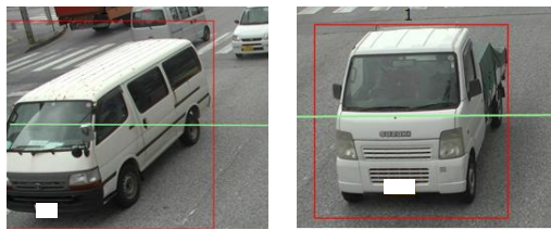
ワゴン車 (大型車として誤認識) 軽トラック (大型車として誤認識)
