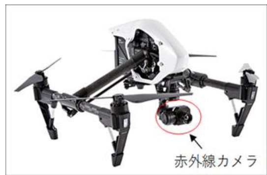
図-4 実験に使用したドローンと赤外線カメラ
