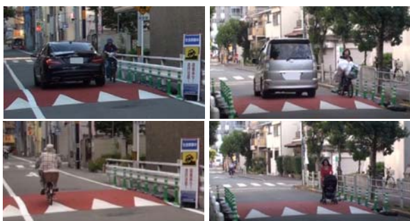
図-9 可搬型ハンプ通行状況
