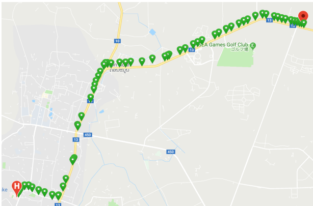
図-13 搬送時にサーバと通信が確認できたポイント
