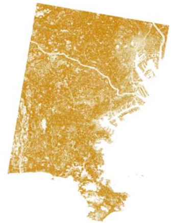
図-3 水災害のためのALOS衛星から抽出した木造住宅の分布図。黄色土色部分の画素が木造住宅, 10mの分解能で5220x7017画素範囲。
