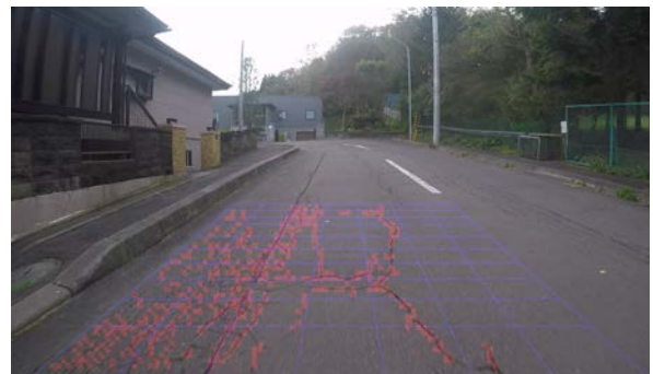
図-5 CNN によるひび割れ検出の例
