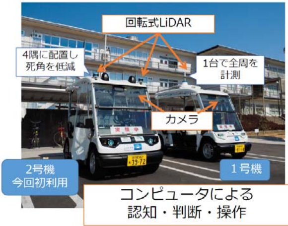
図4 自動運転実証実験に用いた車両
