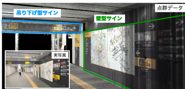
図-2 可視化した点群データと現実空間の比較
