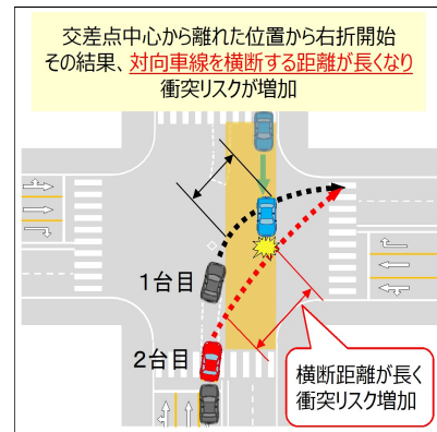
図-3 追従右折車両の事故発生メカニズム
