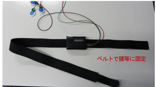
図-3 心拍計とその装着方法
