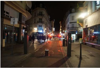
図-6 ライジングボラードにより自動車の進入を制限
