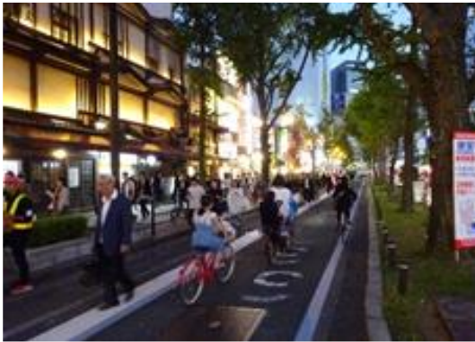
図-12 実験前半の路面標示による分離
