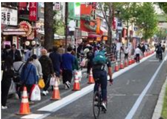
図-13 実験後半の路面標示とカラーコーンによる分離
