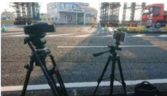
図-4 Bluetooth スキャナ、ビデオカメラ設置状況
