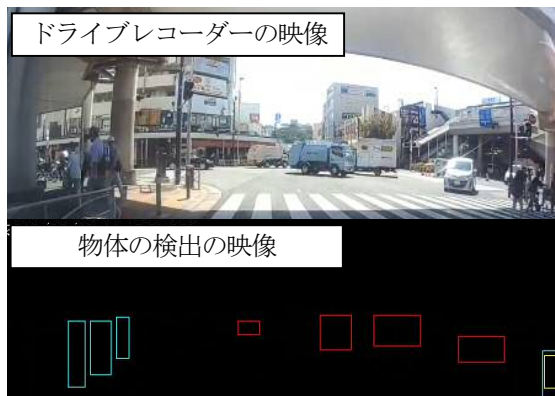
図-7 カメラ映像の物体検知
