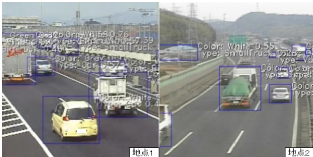
図-2 AI 交通量観測技術によるサンプル映像観測の一例
