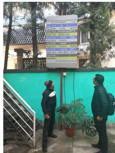
図-6 バス接近情報表示板のプロトタイプ
