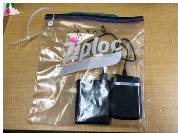
図-4 運用したバス位置情報発信機器
