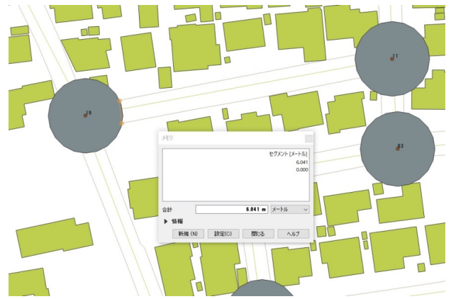
図-5 道路幅員計測方法
