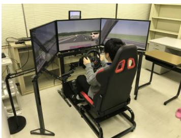
図-2 ドライビングシミュレータ実験装置
