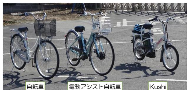
図-1 Kushiと自転車・電動アシスト自転車の外観比較
