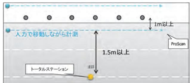
図-13 地上型レーザスキャナ計測方法
