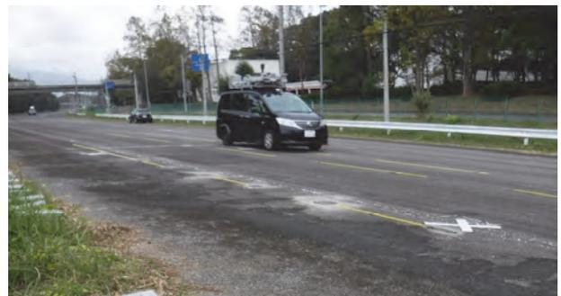
図-3 試験走路での三次元点群データ取得状況
