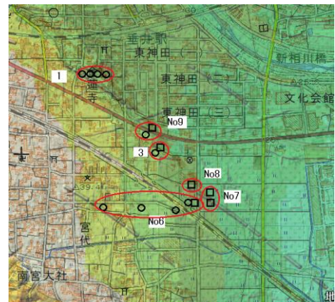
図-3 垂井町南部 (金蓮寺南・宮代) (図3~5: 図中の番号は表-1の連番, △: 取水口, ○: 堅穴, □: 吐水口)
