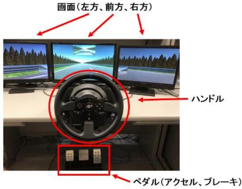
図-4 ドライビングシミュレータの構成
