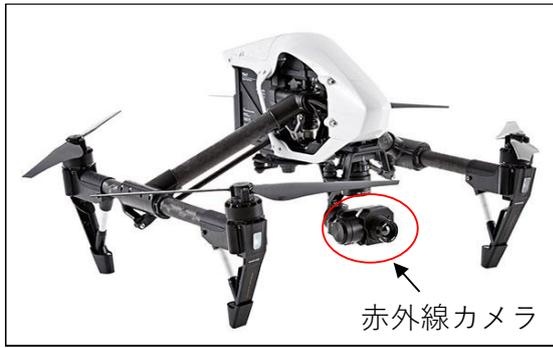
図-5 法面の撮影に用いたドローン<sup>9)</sup>
