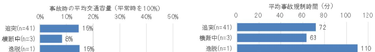
図6 事故時の平均の交通容量・事故規制時間
