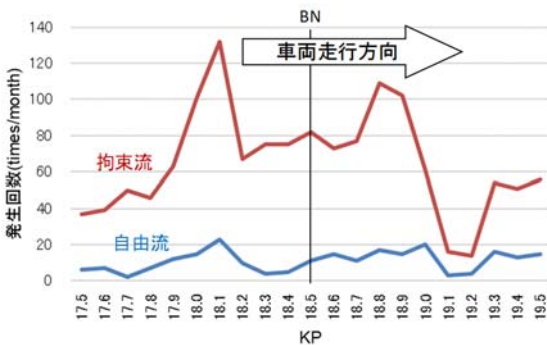
図-9 急挙動発生状況の例 (川口 JCT~川口東)
