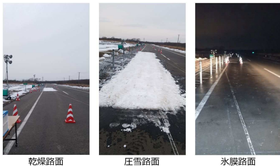
図-7 実験(2)実施区間の路面雪氷状態
