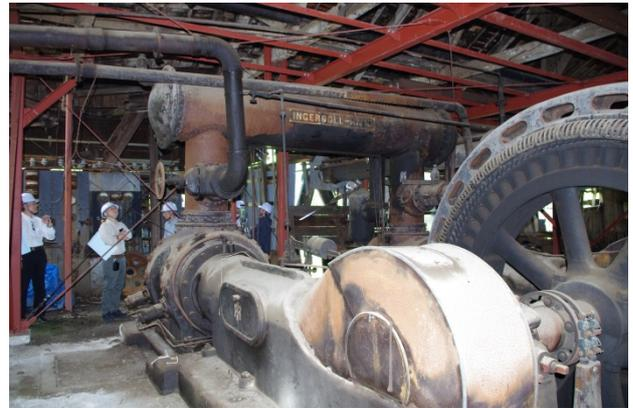
写真-2 本山動力所の内部と残存する圧気機
