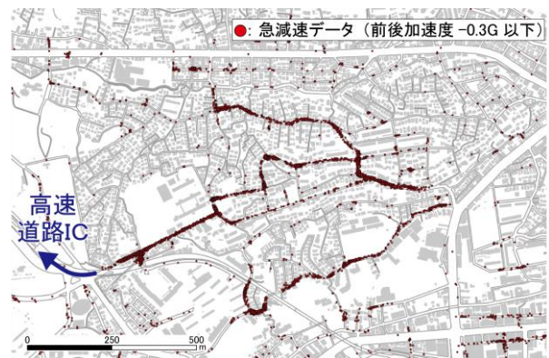
図-7 急減速の密度が高いにも関わらず事故の密度が低い箇所（急減速の分布）
