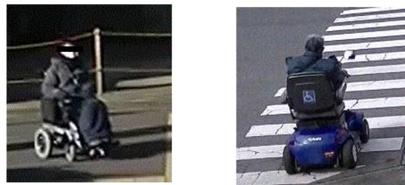
図-1 電動車いすの種類（左：車いす型、右：ハンドル型）
