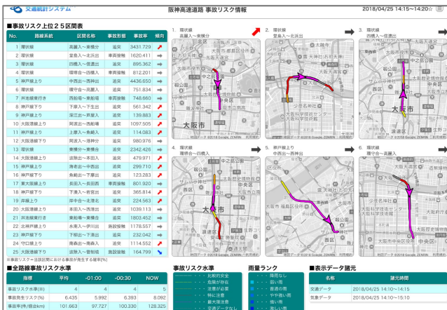
図4 管制室に設置したリアルタイム事故リスク表示端末画面
