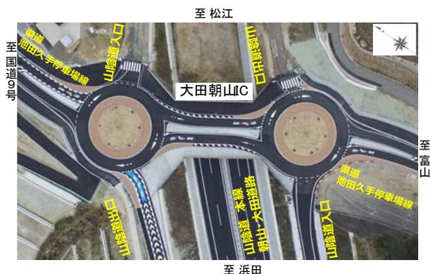
図-1 大田朝山 IC に導入したツインラウンドアバウト
