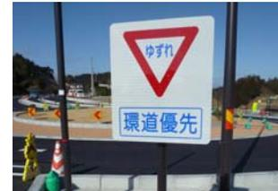
図-20 環状交差点の規制標識を補完する法定外標識
