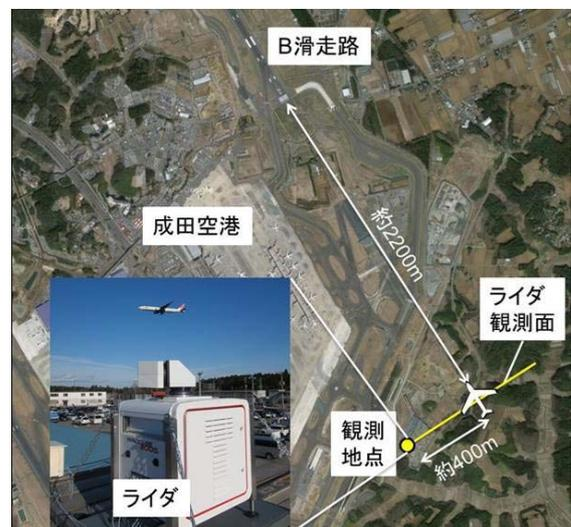
図-8 成田空港での後方乱気流計測
