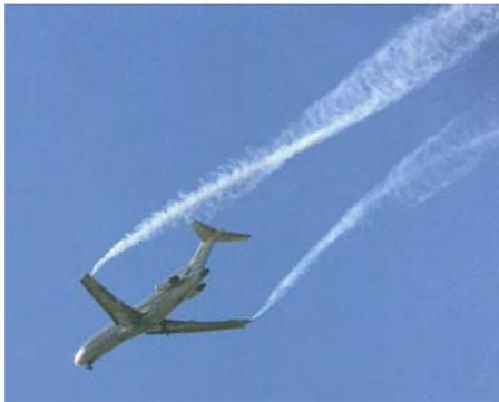
図-2 煙で可視化された後方乱気流 (出典：NASA)
