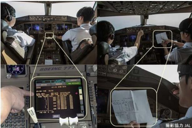
図4 飛行中にALWINを参照している様子 (JAL 提供)
