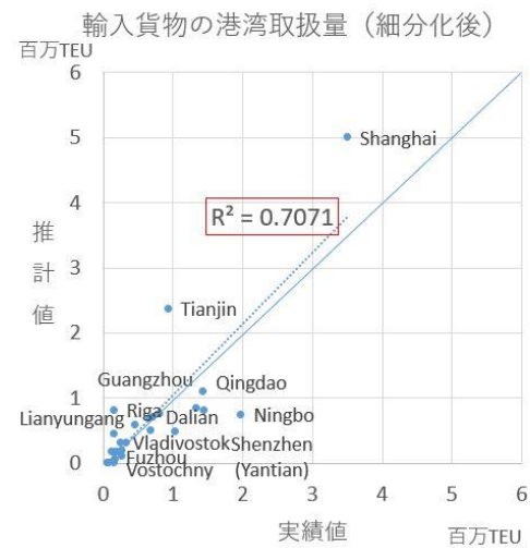
図-4 陸上輸送ネットワークと接続する港湾の輸入実入りコンテナ取扱量の実績値とモデル推計値の比較
