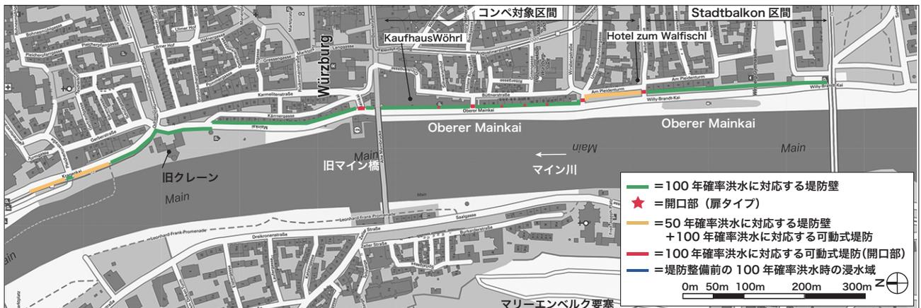
図-4 整備全体平面図 (地形図に筆者加筆)
