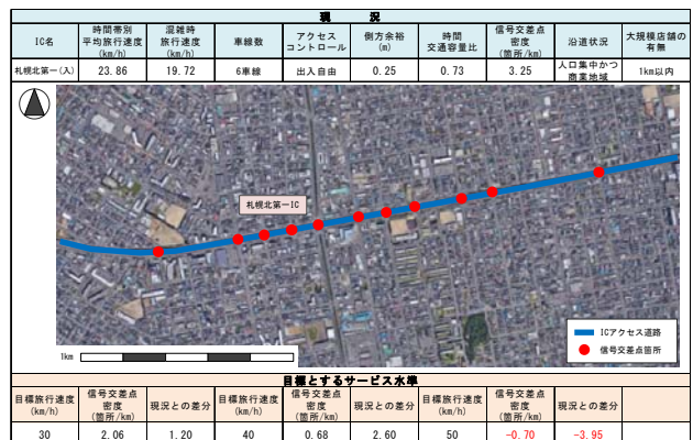
図-10 目標とするサービス水準と道路構造条件の算定例
