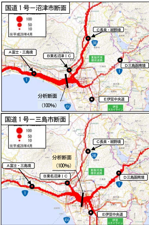
データ：ETC2.0プローブデータH28.4 提供：国土交通省中部地方整備局沼津河川国道事務所 図4 拠点エリア内の幹線道路断面における経路分析結果
