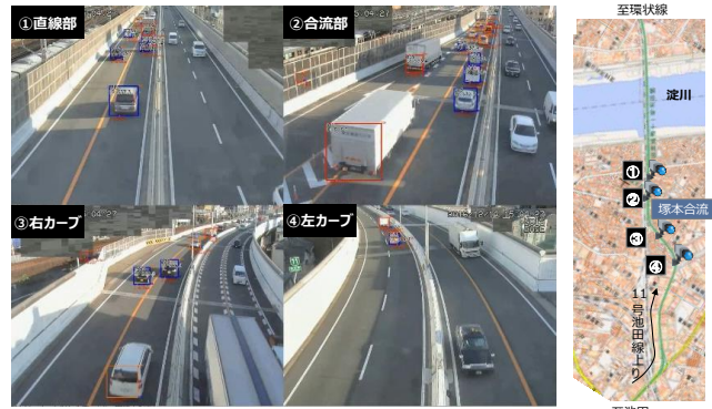
図-7 画像センシングによる車両検出状況 (塚本合流付近)
