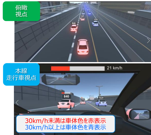
図-17 合流車の影響による速度低下の伝搬状況
