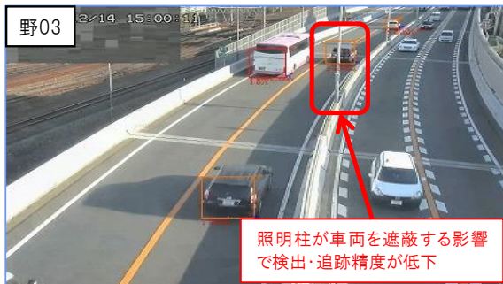
図-10 照明柱による一時的な遮蔽による追跡の途切れ
