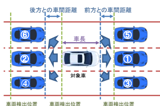
図-16 車両軌跡と影響因子が関係化されたデータベースの構成
