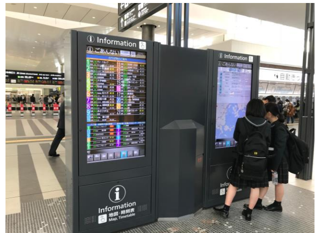
図-5 広島駅タッチパネル式DSとバスロケーション情報表示
