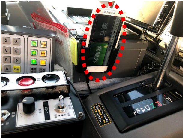
図-7 バスの車載端末
