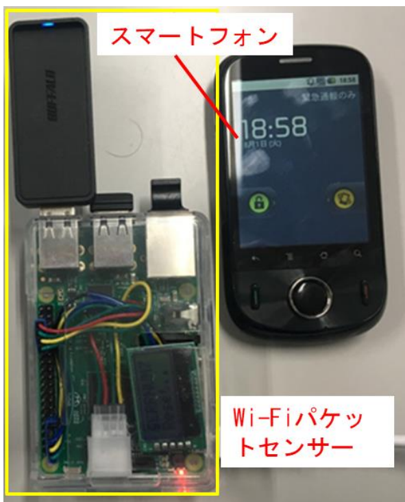
図-1 Wi-Fi パケットセンサー
