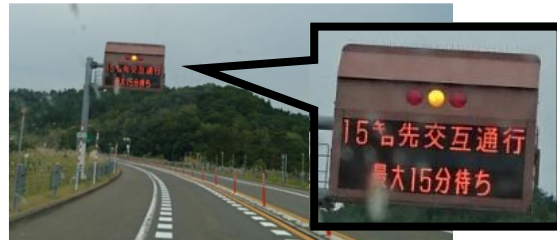
図-1 道路情報版の例(最大15分待ちと示されている)
