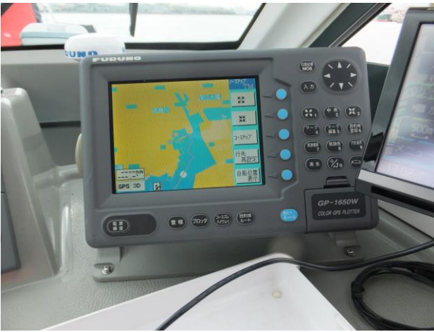
図-2 むこ丸搭載の電子海図表示装置
