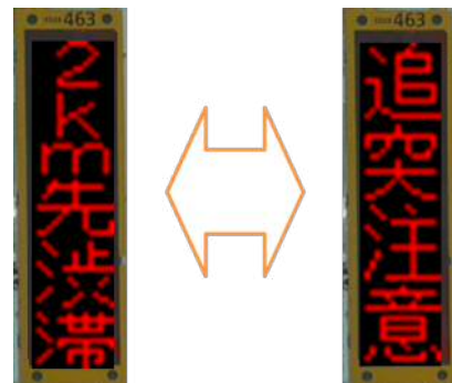
図-4 表示内容例(中央分離帯側・渋滞時)
