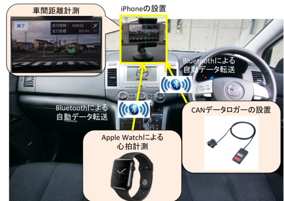
図-2 モバイル型運転挙動計測システムの構成要素
