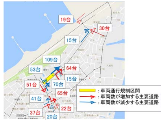
図-5 通行規制による通学時間帯(7:30~8:30)の交通量増減のシミュレーション結果を視覚的にまとめたもの
