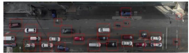
図-8 現地撮影画像の車体検出結果(パラメータ変更後)
