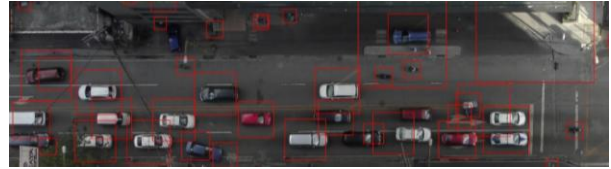
図-7 現地撮影画像の車体検出結果(パラメータ変更前)
