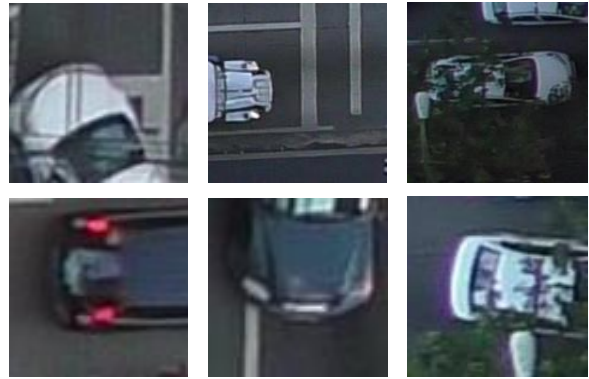
図-11 負例画像として追加した欠損検出画像の例
