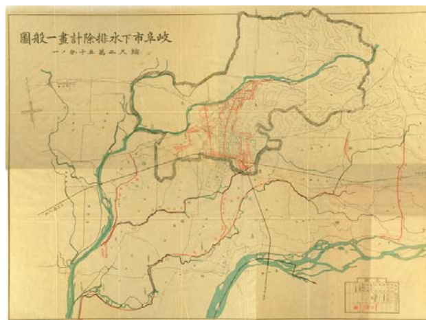
図-1 岐阜市下水排除計画一般図
